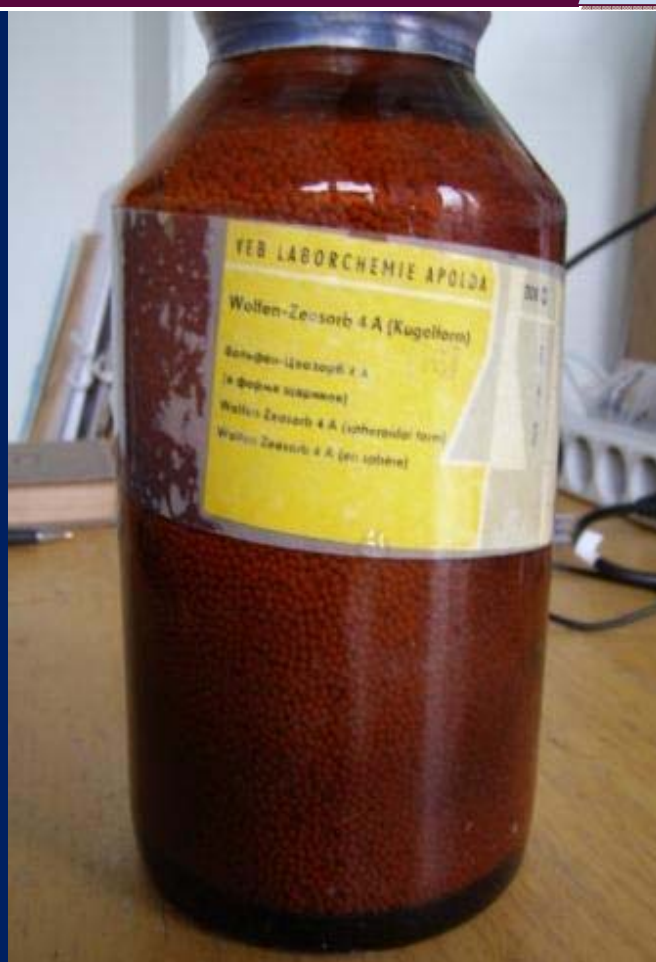
Цеолиты с размером каналов 4А. Выпущены еще до объединения Германии. (фото В.Н. Витер)
